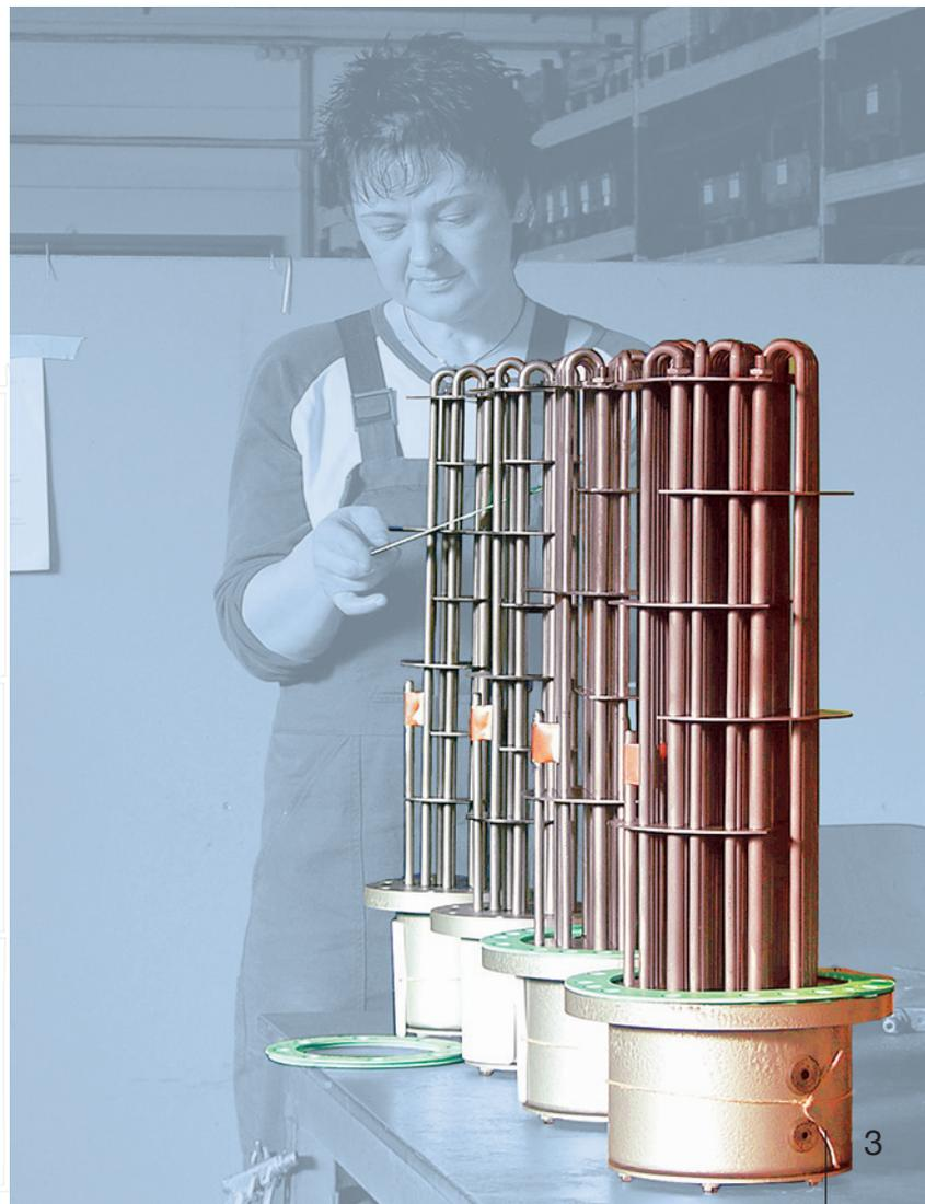
Качество означает надежность. Каждый аппарат производства FUNKE проходит гидравлические испытания и другие типы контроля согласно требованиям заказчиков и действующим нормам сертификационных органов, к основным из которых относятся:
